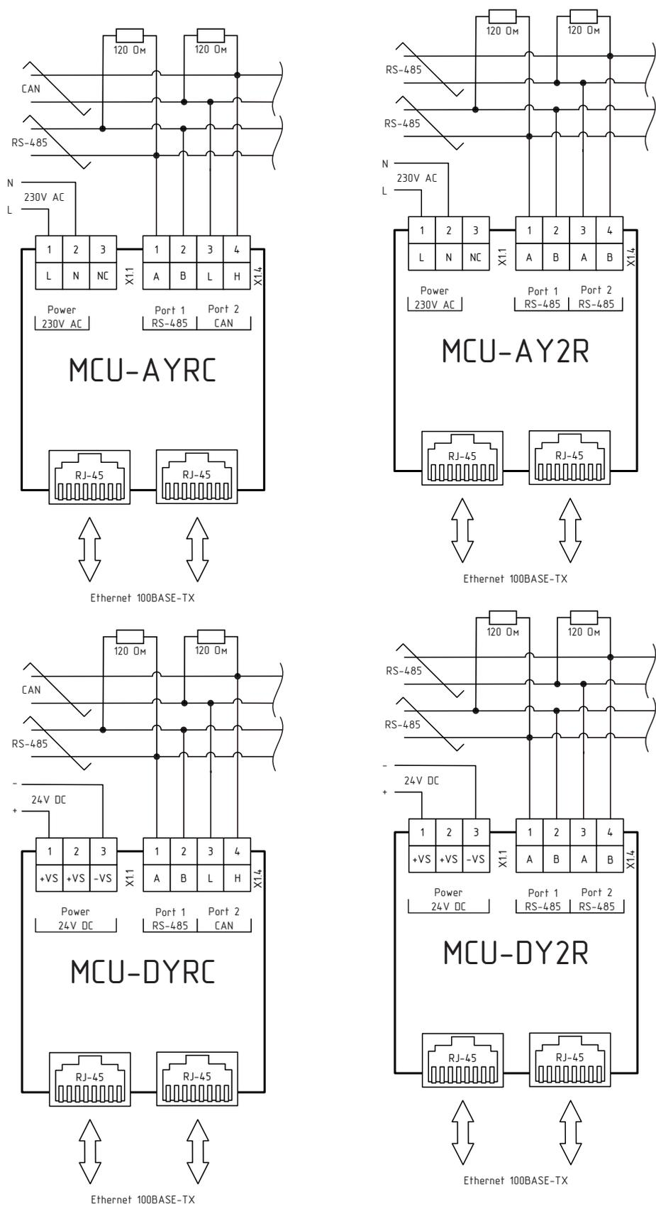
Рисунок 1.10 – Схемы подключения MCU-xY
