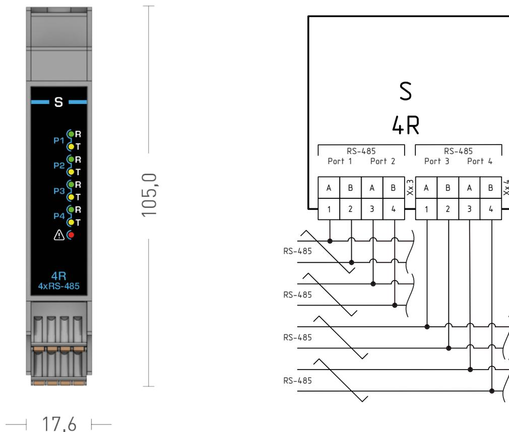
Рисунок 1.24 – Внешний вид и схема подключения модуля расширения S-4R
