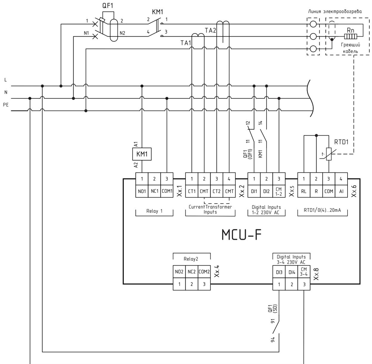
Рисунок 1.23 – Схема подключения модуля расширения MCU-F
