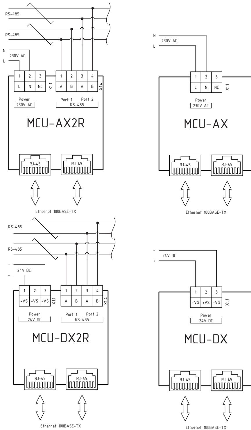
Рисунок 1.8 – Схемы подключения MCU-xX
