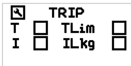
Рисунок Д.4 – Флаги защитного отключения
