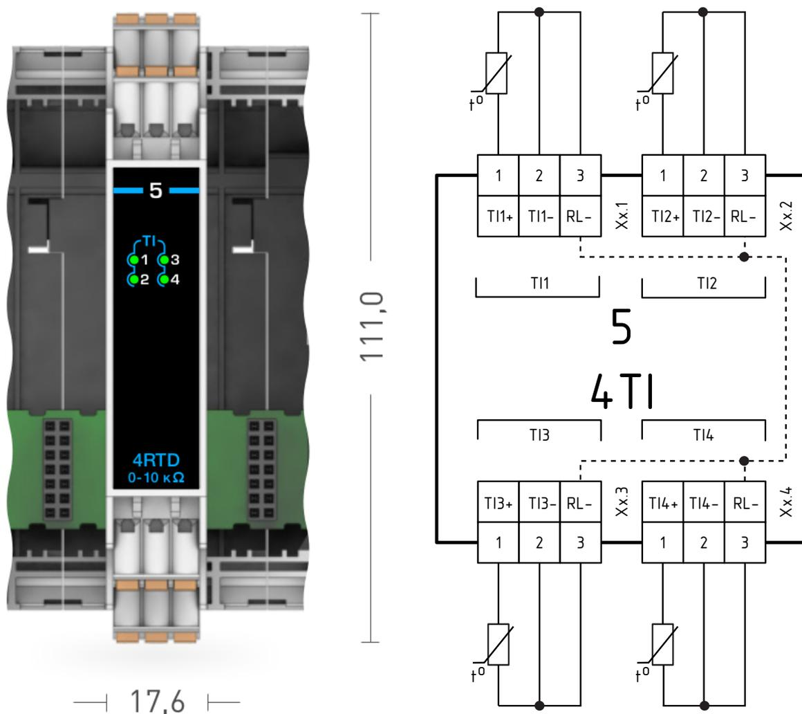
Рисунок 1.15 – Внешний вид и схема подключения модуля расширения MCU-5-4RTD
