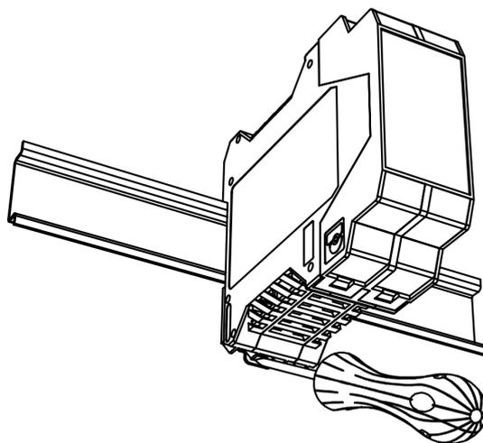
Рисунок 2.2 – Демонтаж устройства с DIN-рейки
