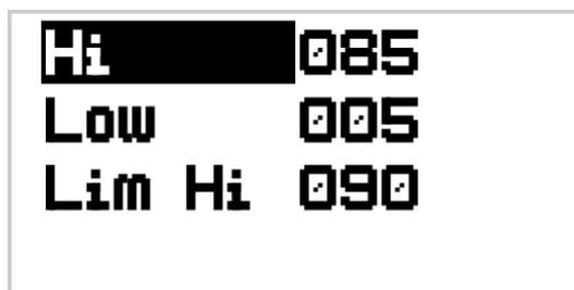
Рисунок Д.10 – Установка предельных значений по температуре
