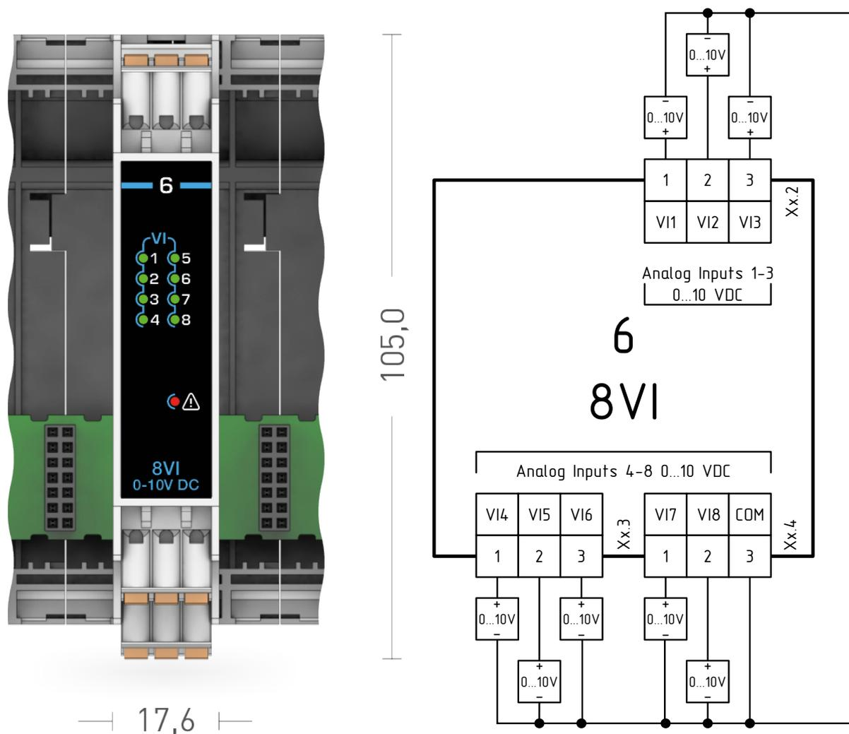
Рисунок 1.16 – Внешний вид и схема подключения модуля расширения MCU-6-8VI
