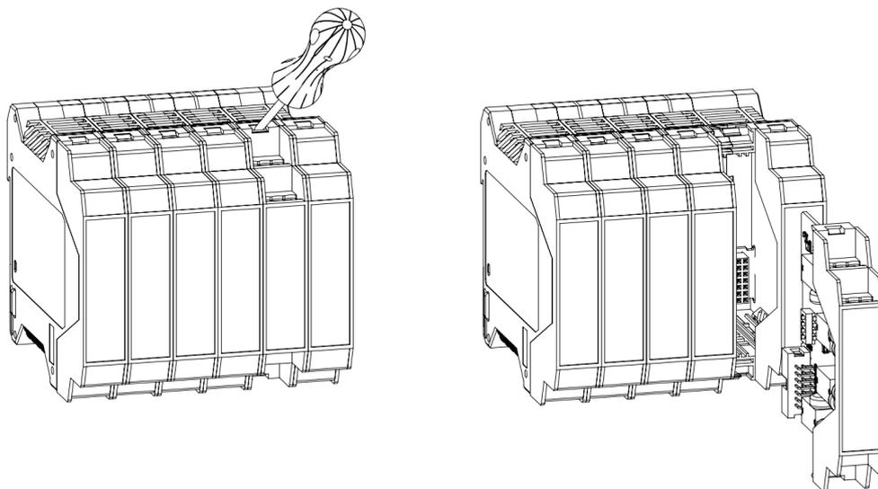
Рисунок 2.4 – Демонтаж модуля
