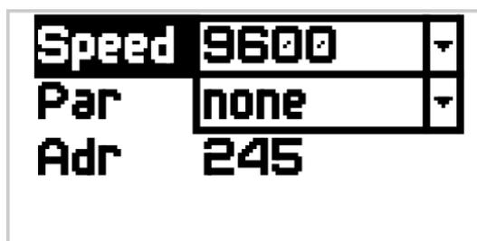
Рисунок Д.14 – Настройки протокола связи по протоколу RS-485
