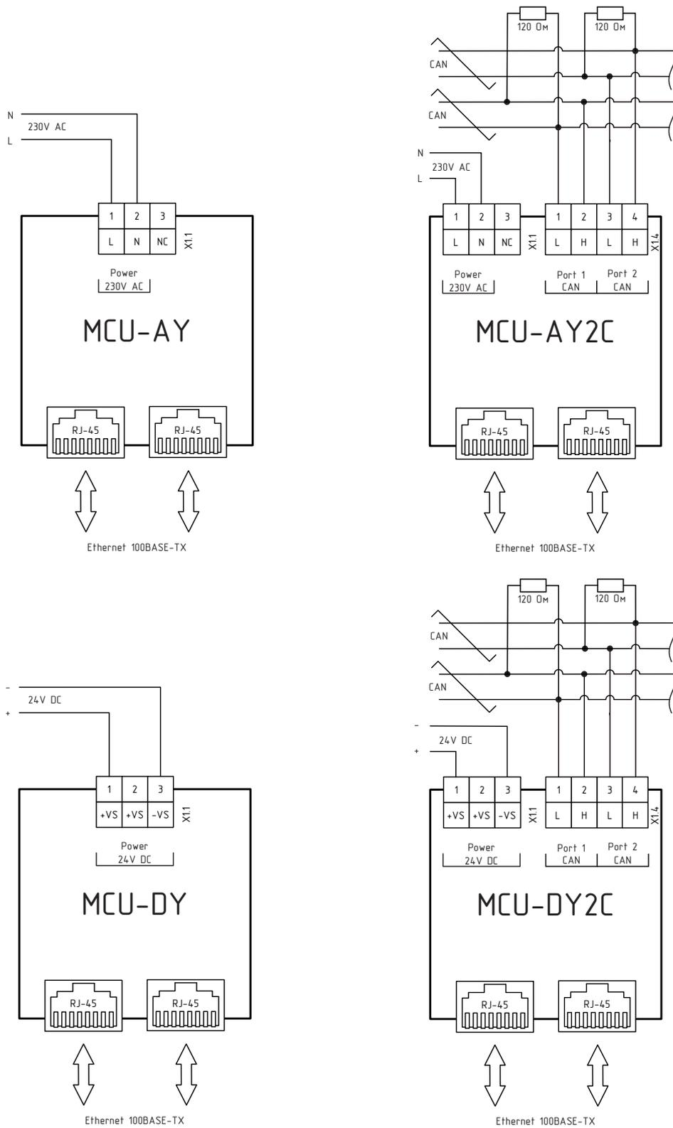
Рисунок 1.9 – Схемы подключения MCU-xY
