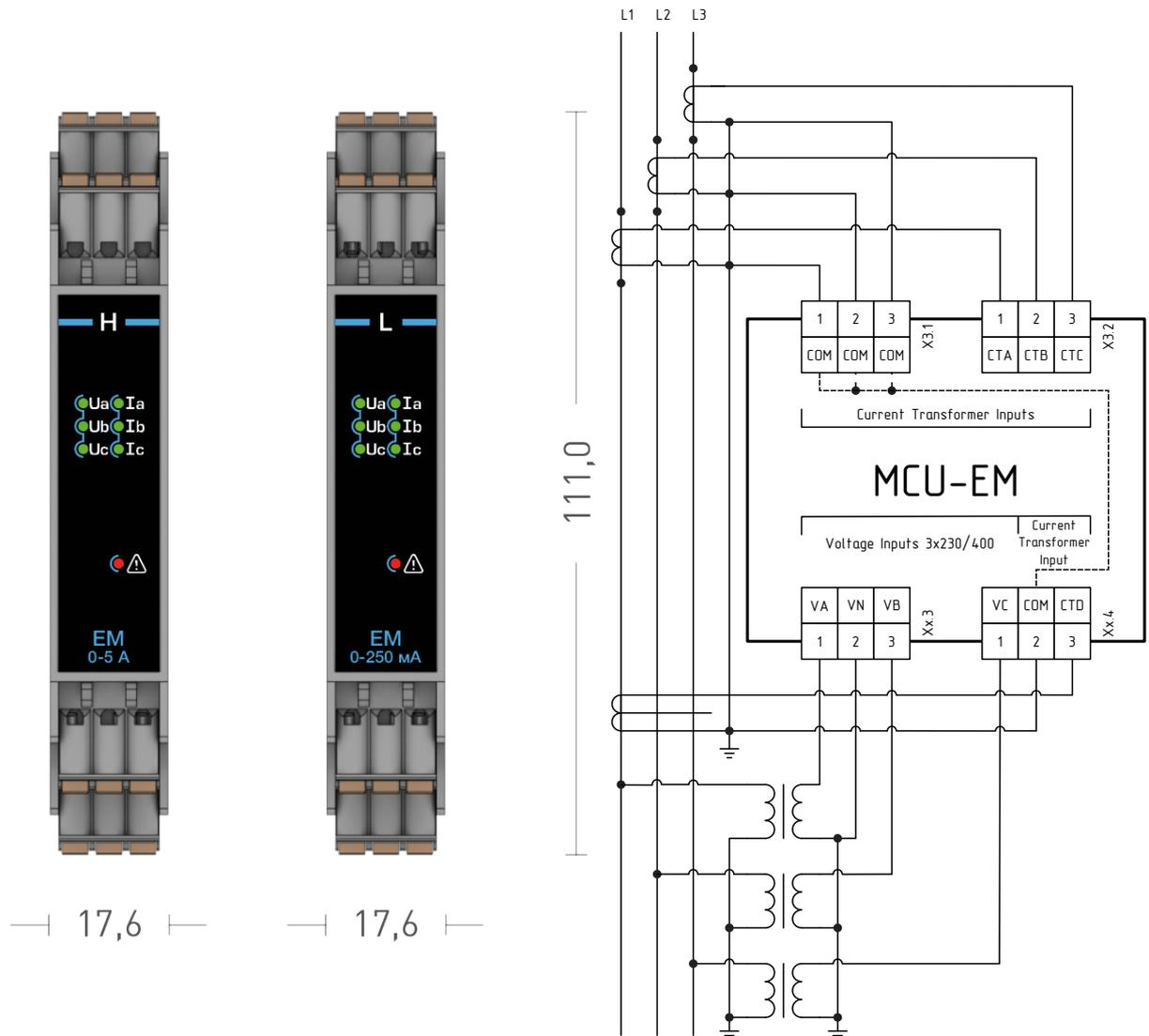
Рисунок 1.21 – Внешний вид и схема подключения модуля расширения EM
