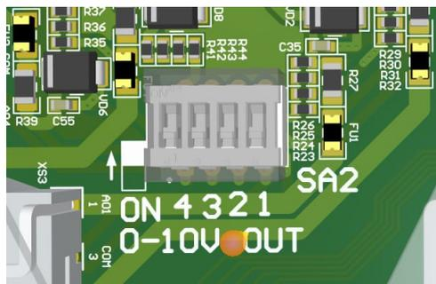
Рисунок 1.18 – Нумерация каналов и переключатели режимов на плате MCU-7-4AO
